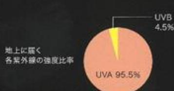
紫外線は、地球上に到達する太陽光線のうち、通常190~400nmの波長の光線を指し、波長の短い方から、UVC:290nm以下、UVB:290~320nm、UVA:320~400nmに分類されます。このうちUVCについてはオゾン層で遮られ、地上には到達しません。地上に到達して塗膜劣化の原因になる紫外線は、UVBとUVAです。その中でも、地上に到達する光のエネルギーの強度比率でみると約95.5%がUVAとなります。
